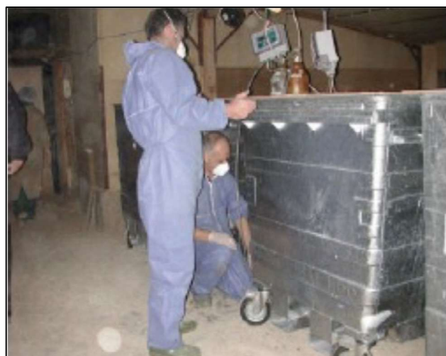
Figura 7. Attrezzatura per l'esposizione a gas in contenitori a tenuta (EFSA, 2019 1 )
