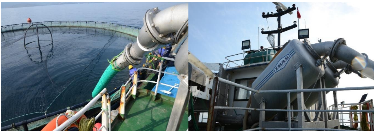
Immagine 3. Il tubo (a sinistra) e la pompa (a destra) spostano i pesci in acqua dal recinto allo storditore.
