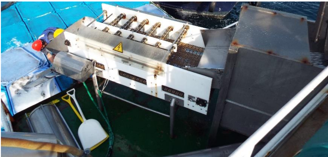
Immagine 3a. La macchina per lo stordimento usata da SÜRSAN per stordire orate e branzini. Nel lato destro della foto si può vedere l'unità di disidratazione in cui i pesci vengono separati dall'acqua.
